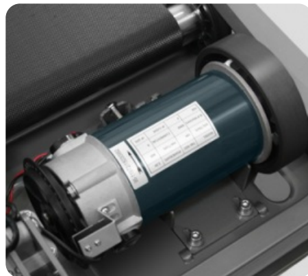
Двигатель Schneider Electric мощностью 1,5 л.с.
