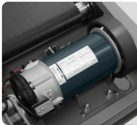
ДВИГАТЕЛЬ SCHNEIDER ELECTRIC МОЩНОСТЬЮ 1,75 Л.С.
